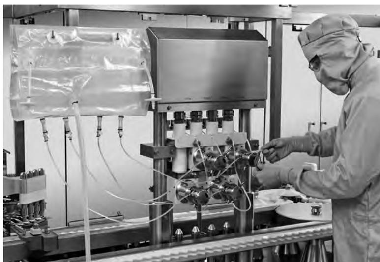
Remplissage aseptique de médicaments avec le nouveau système de remplissage aseptique PreVAS de Bosch ©Sartorius
